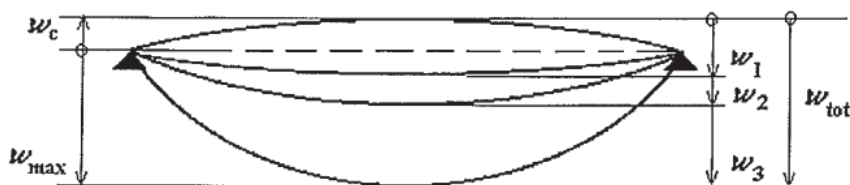
Slika 3: Omejitve pomikov konstrukcije
